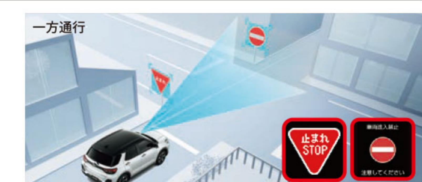
進入禁止、最高速度、一時停止の標識をステレオカメラが検知するとディスプレイに表示してお知らせします。道が入り組んだ住宅街や高速道路での運転時などに役立ちます。
