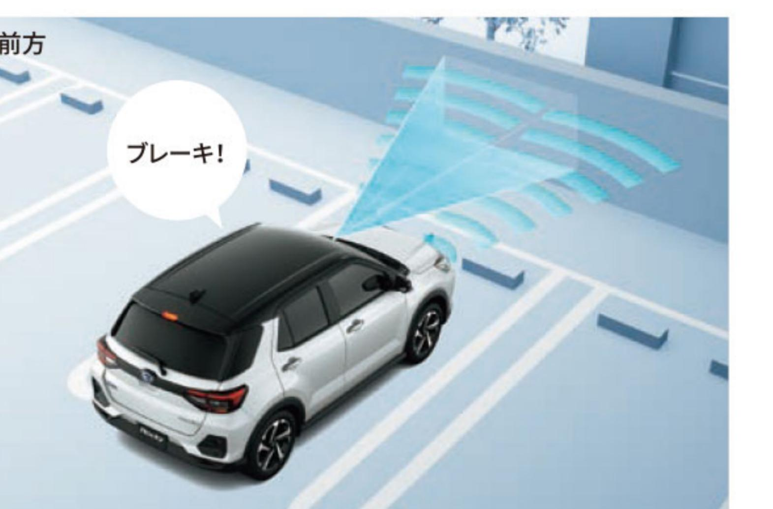
前方約4m以内に障害物等があることをステレオカメラまたは約2~約3m以内に障害物等があることをソナーセンサーが検知している時に、シフトポジションを[D]、[S]、[M]、[B]にしたままブレーキペダルと間違えるなどして必要以上にアクセルペダルを踏み込んだ場合、急発進を抑制します。
