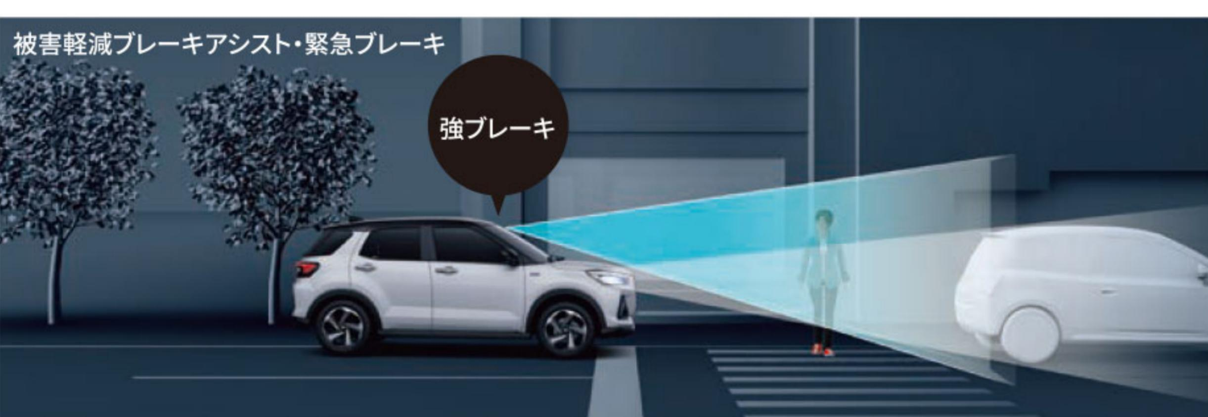
走行中に前方の車両(二輪車、自転車含む)や歩行者(昼夜対応)をステレオカメラが検知し、衝突の危険性があると判断した場合、ブザー音とディスプレイ表示で警告します。衝突の危険性がさらに高まるとシステムが判断した場合、弱いブレーキをかけます。
