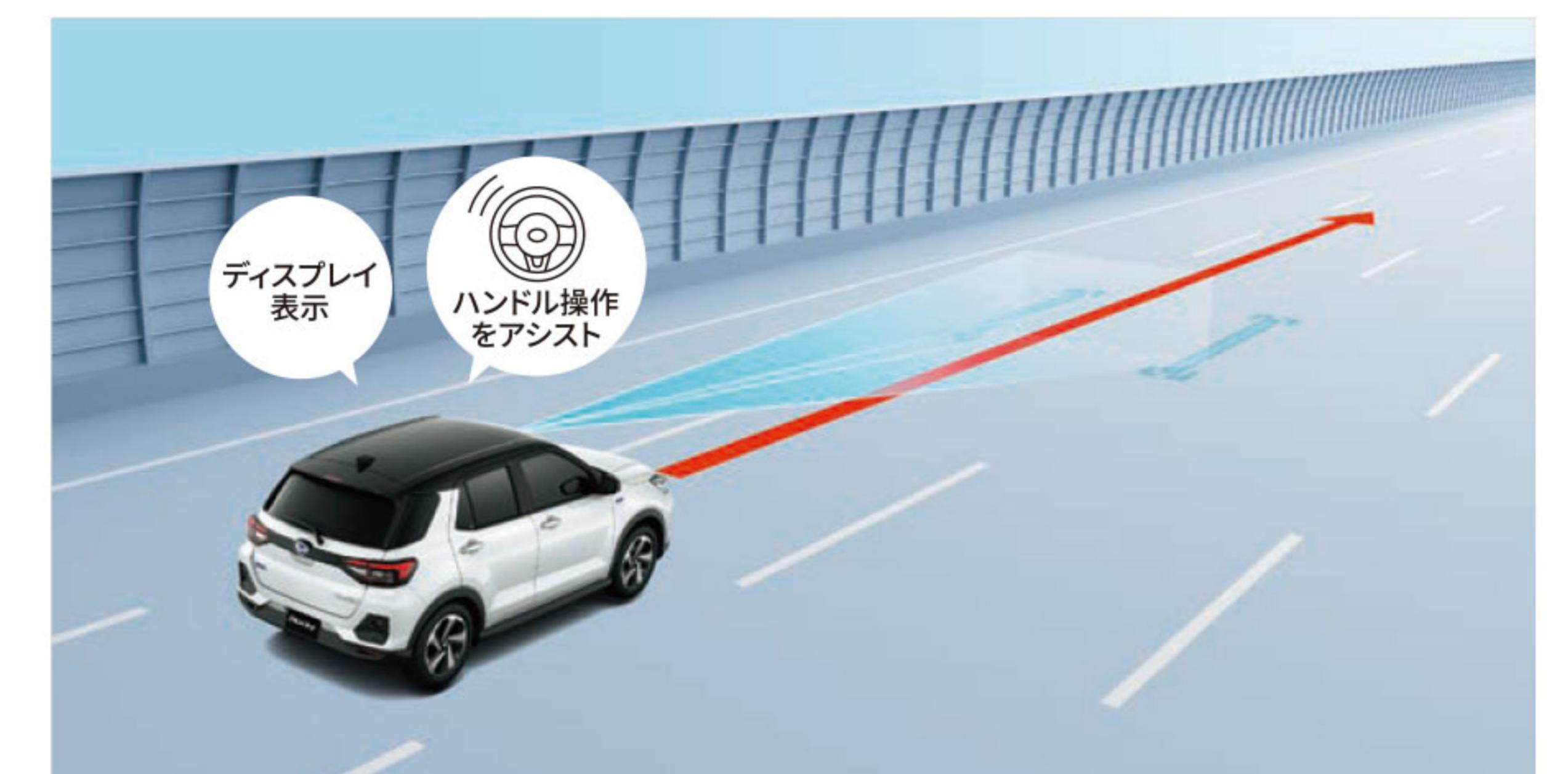
●LKC=Lane Keep Control ■次のような場合は、適切に作動しないことがあります。●悪天候(豪雨・吹雪・濃霧など)により白(黄)線が見えにくい時 ●前方から強い光(太陽光などによる逆光や対向車両のヘッドライトの光など)を受けている時や、強い光が道路に反射している時 ●夜間に街灯のない道路を走行している時 ●急なカーブのある道路を走行する時 ●フロントウインドウ外側が汚れ、泥、湿った雪に覆われている時 ●フロントウインドウ内側が曇っている時 ●先行車との車間距離が短い時 ●自車が白(黄)線に対してまっすぐに走行していない時 ●料金所や検札所の手前や交差点など、白(黄)線がない場所を走行する時 ●白(黄)線が不明瞭または直線的でない時など 詳しくは取扱説明書をご確認ください。
