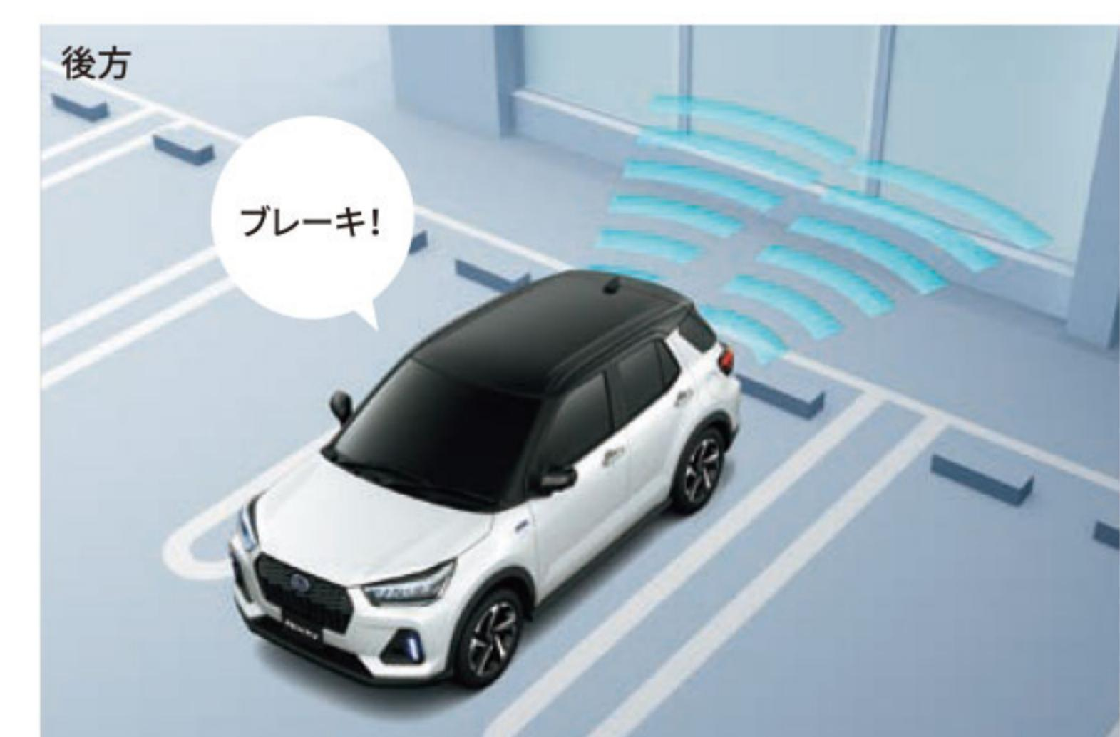
後方約2~約3m先までに壁などの障害物等があることをソナーセンサーが検知している時に、シフトポジションを[R]にしたままブレーキペダルと間違えるなどして必要以上にアクセルペダルを踏み込んだ場合、急発進を抑制します。
